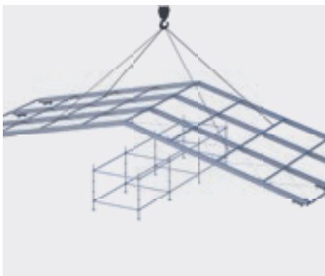
Montage der einzelnen Segmente am Boden und Positionierung per Kran
